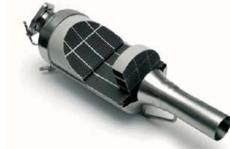
Filtr pevných částic u vozu Superb
