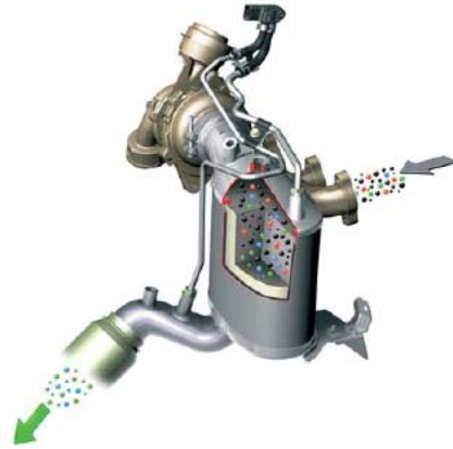
Filtr pevných částic u vozů Octavia / Roomster
